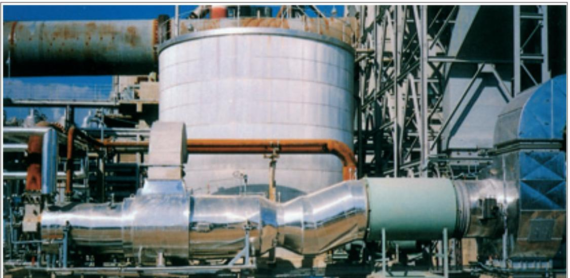
*Фирма Dongae Pulp Co., Южная Корея, завод по производству сульфатной целлюлозы. Горелка MT-12 S для установки по сжиганию дурнопахнущих газов.*
